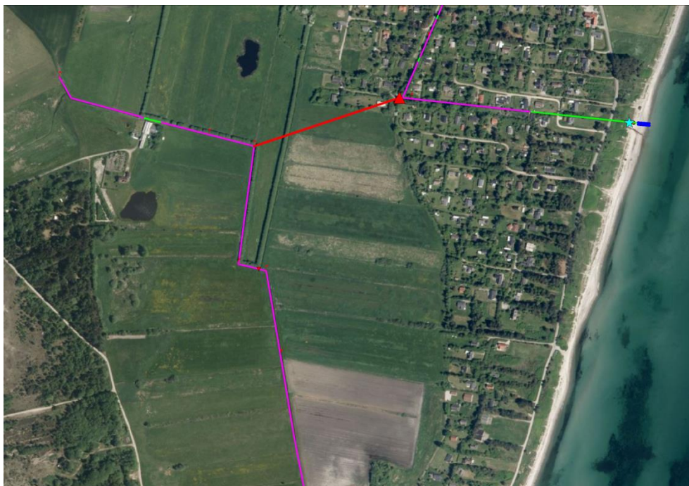
Figur 2: På oversigtskortet ses den nederste del af Tuekærgrøften og en del af Vestensøkanal (åben = pink, rørlagt = grøn). Endvidere ses foreslået spunsning (mørk blå) samt foreslået placering af en højvandsklap (lys blå stjerne). Ligeledes ses det foreslåede overløb (rød trekant) samt det nye grøfteforløb der skal lede overløbsvandet ned til Vestensøkanal (rød streg).
